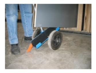
**Schritt 2**Lager-Hilfswagen unterschieben und mit der Haltestange die Platte heraus fahren.
